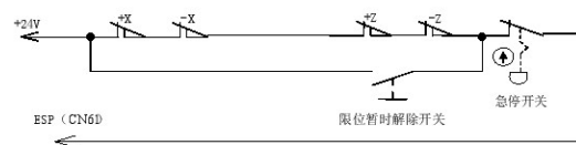
图 2-34A 急停、行程开关串联连接
