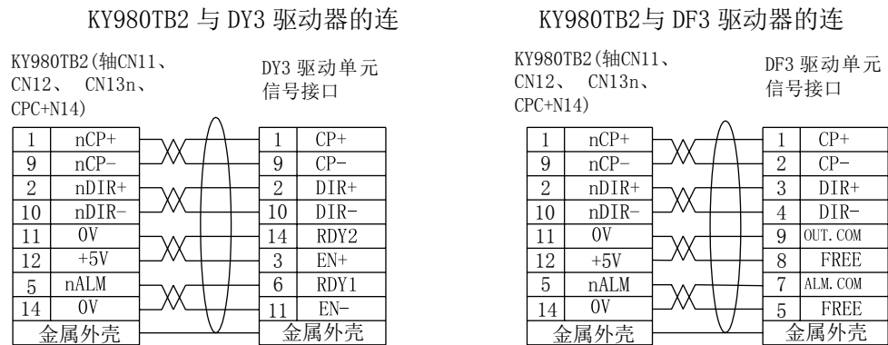
图 2-11 KY980TB2 与驱动单元的连接
