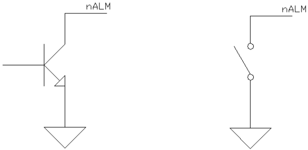
图 2-4 驱动单元提供信号的方式
